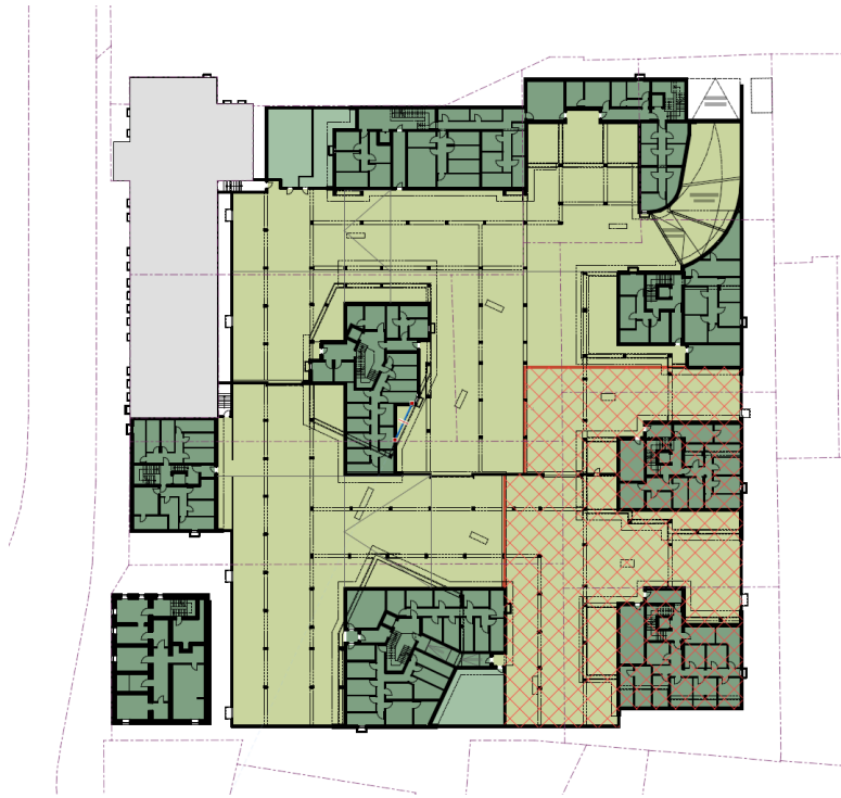
Tiefgarage mit 148 Plätze und Kellerräume
